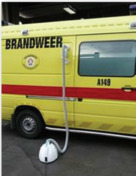
Насадка-пистолет с удлинительным шлангом для обработки помещения извне
