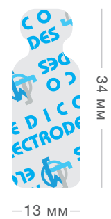
3413MED взрослый/педиатрический Вид геля: твердый Основа: лента (бумага/ПЭТ) Коннектор: Графитовый «слип-клип», под прищепку «крокодил» Упаковка: 100/1000/10000 Использование: покой, мониторинг
